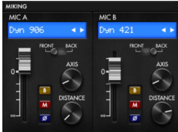
Toute Enceinte Virtuelle Two notes est liée à une collection propre de 8 microphones. Vous accédez à la liste des micros en cliquant sur la fenêtre bleue au-dessus du fader des tranches A et B. les micros sont décrits par leur technologie : DYN pour microphone dynamique, CND pour microphone à condensateur et RBN pour microphone à ruban.
