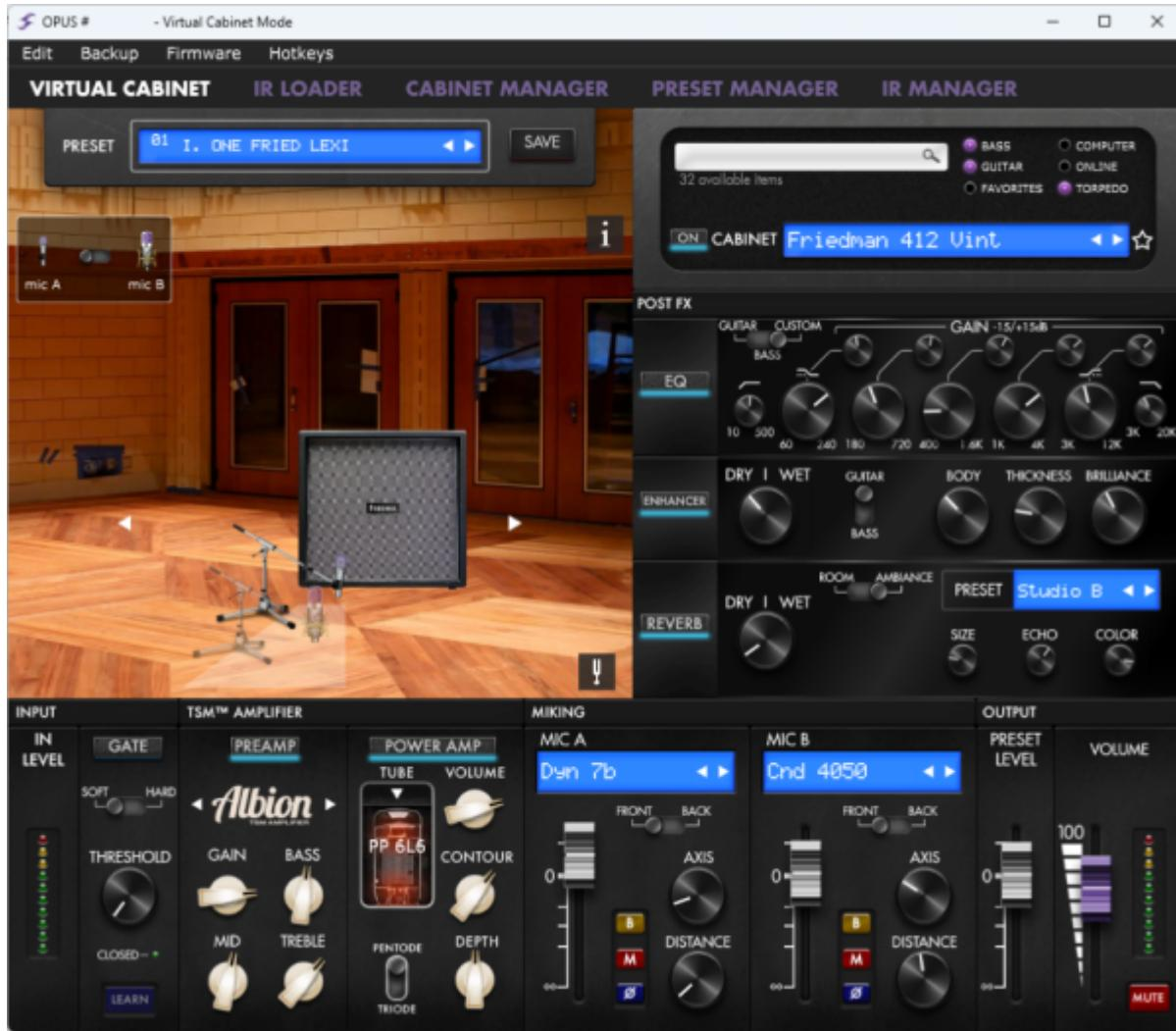
La fenêtre principale de Torpedo Remote donne accès à tous les effets, ainsi qu'aux choix de préampli, d'ampli de puissance, d'enceinte et de micro. C'est également ici que vous pourrez gérer la mémoire interne de l'appareil via les onglets en haut de la fenêtre.
